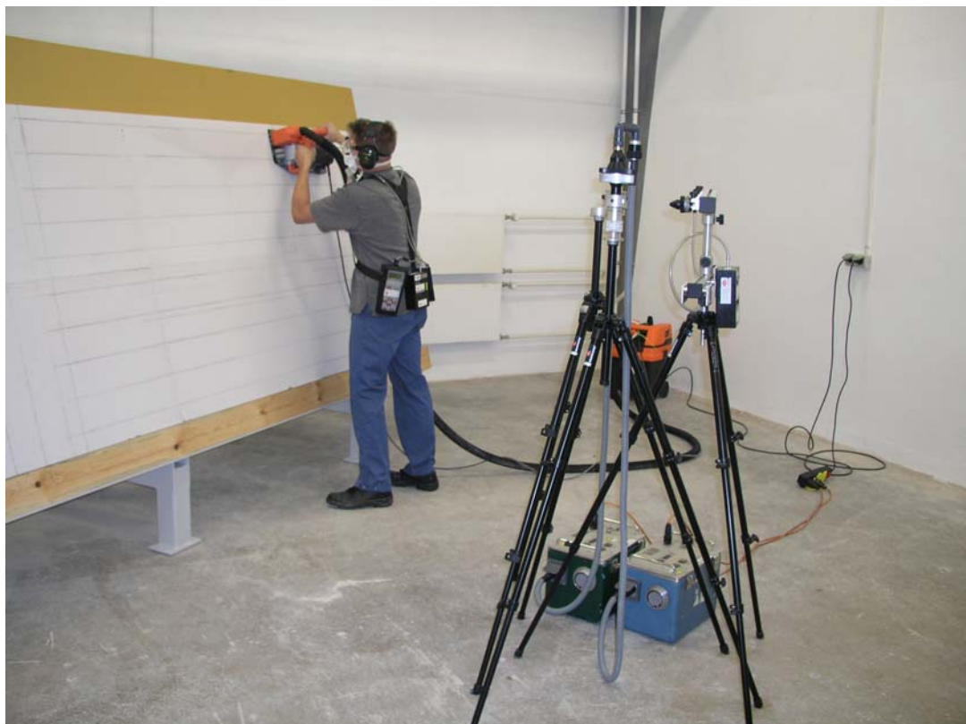
Abb. 5.4.2 - 1 Stationäre Probenahme - Gravikon PM 4 G sowie Gravikon PM 4 F
