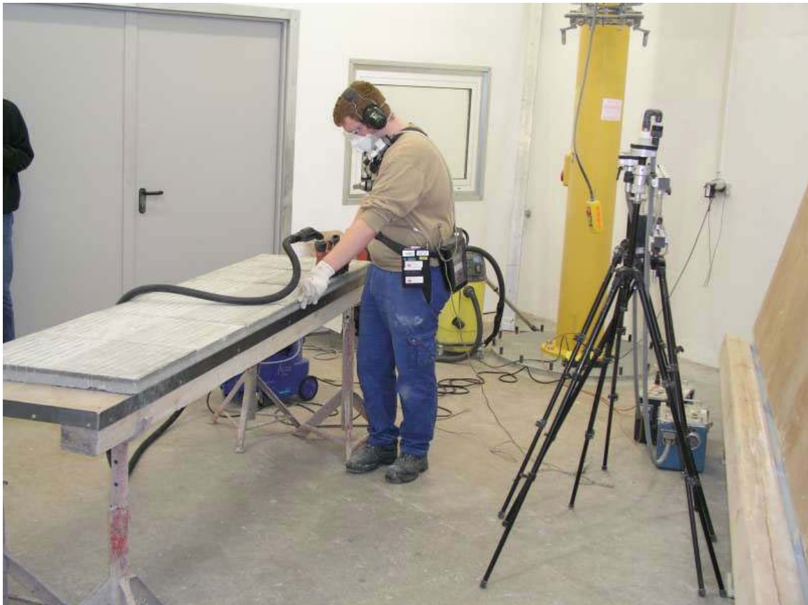
Abb. 6.3.1 - 1 Bockgerüst zur Auflage der Betonplatten zur Untersuchung der Trennschleifer
