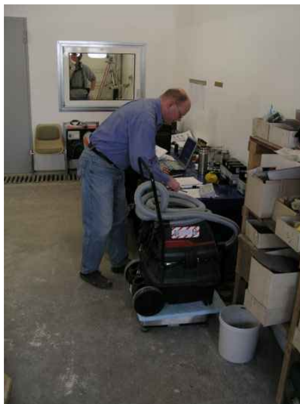
Abb. 5.10 - 2 Wägung eines Mobilentstauber
