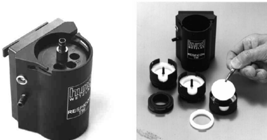
Abb. 5.4.1 - 1 RESPICON und sein dreistufiges Staubsammelsystem
