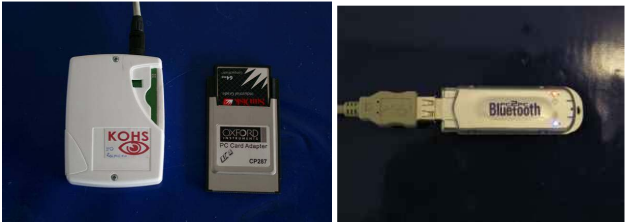
Abb. 5.4.3 - 5 Bluetooth-Datenlogger und -Empfänger am Notebook
