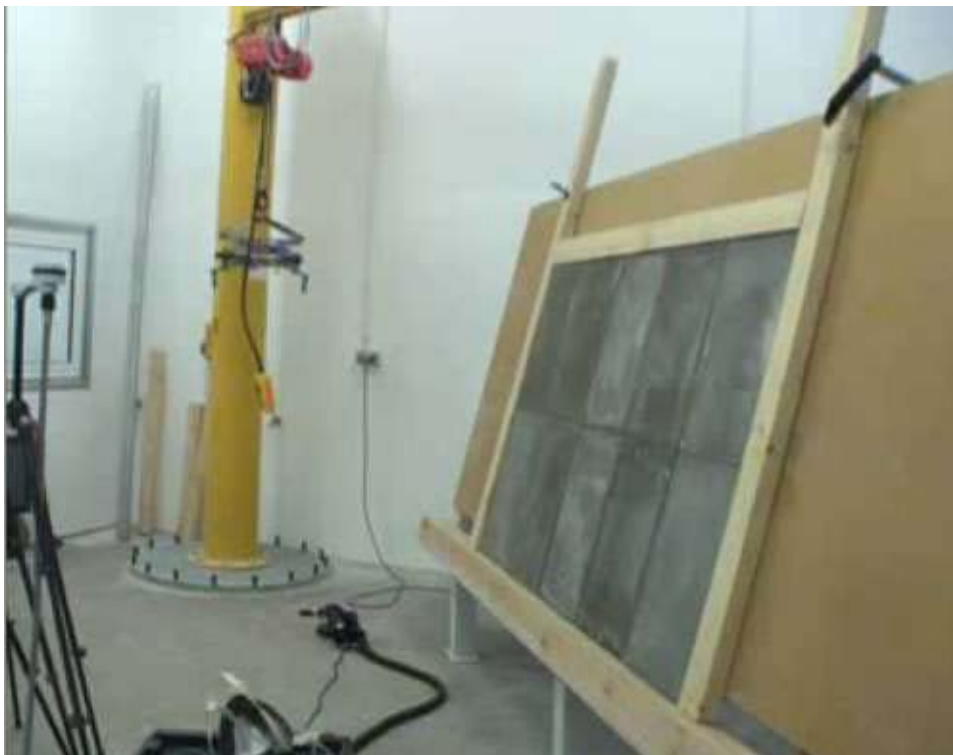
Abb. 6.2.1 - 1 Betonplatten auf dem A-Bock
