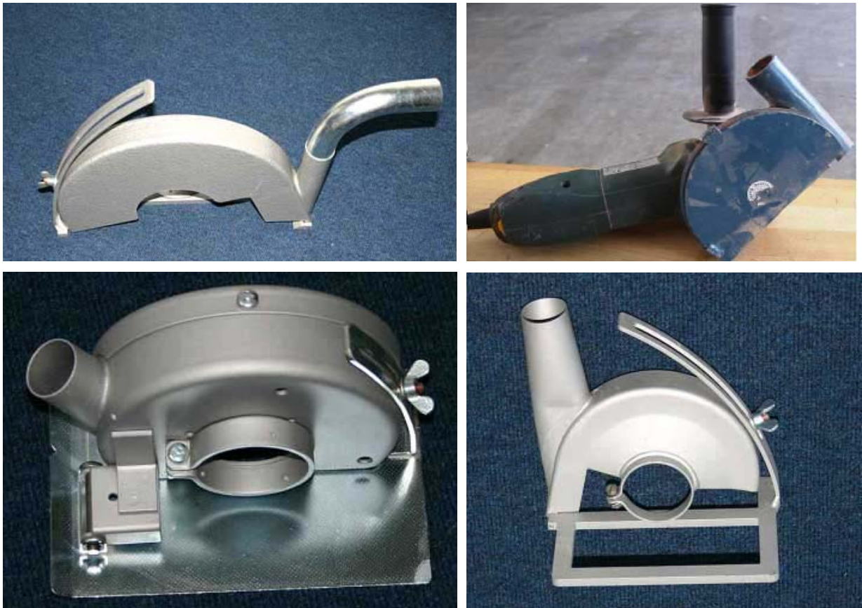
Abb. 7.3.1 – 2 Beispiele einfacher starrer Erfassungshauben
