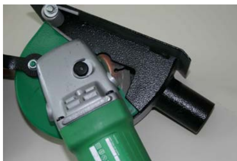
Abb. 7.3.1 – 1 Beispiele angefederter Erfassungshauben
