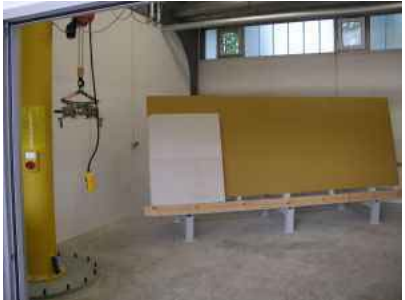
Abb. 5.3 - 4 A-Bock zur Materialauflage im Prüfraum
