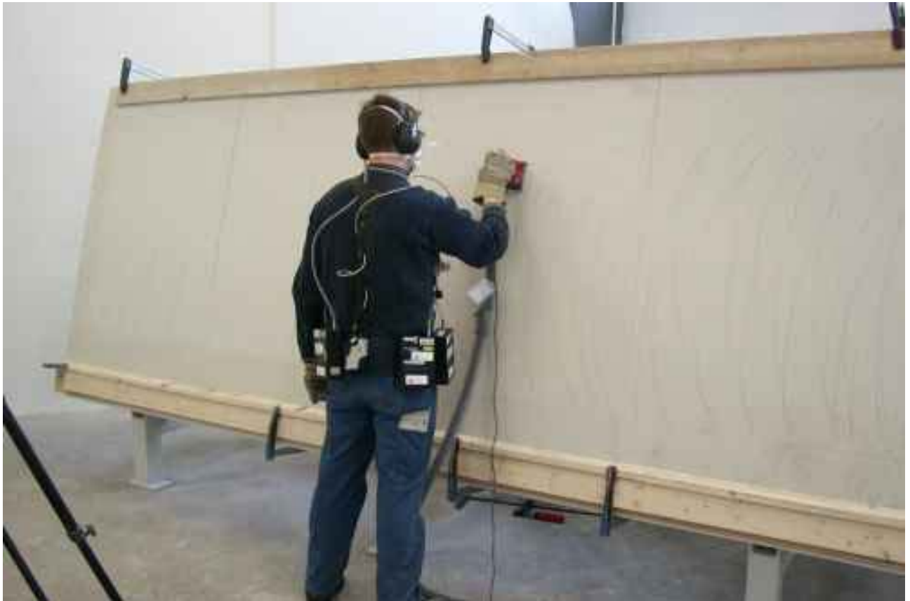
Abb. 6.5.1 - 1 Versuchsaufbau für Schwing- und Exzentrerschleifer
